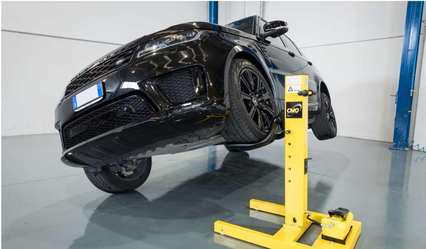
Fonctionnant à l'air comprimé, cet engin de levage hydropneumatique, facile à mettre en oeuvre, permet de mettre à hauteur les parties basses d'un véhicule. Il rend confortable le travail des carrossiers. Capacité de levage maximum **3'000 KG**.
