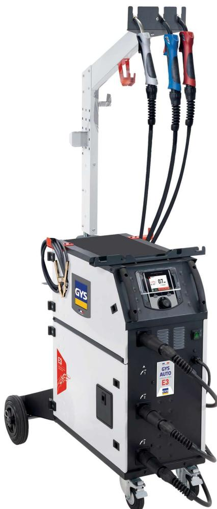
E3 GYS AUTO est un poste à souder MIG/MAG monophasé synergique de 200 A, avec 3 dévidoirs intégrés spécialement conçu pour le carrossier. Équipé d'une interface couleur très intuitive, il soude à la perfection l'acier et l'aluminium même sur faible épaisseur. Ses synergies intègrent également le soudo-brasage avec les fils CuSi3 et CuAl8
