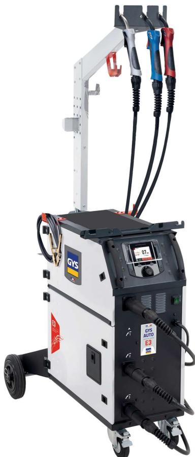
E3 GYS AUTO est un poste à souder MIG/MAG monophasé synergique de 200 ampères, avec 3 dévidoirs intégrés spécialement conçu pour le carrossier. Équipé d'une interface couleur très intuitive, il soude à la perfection l'acier et l'aluminium même sur faible épaisseur. Ses synergies intègrent également le soudo-brasage avec les fils CuSi3 et CuAl8.
