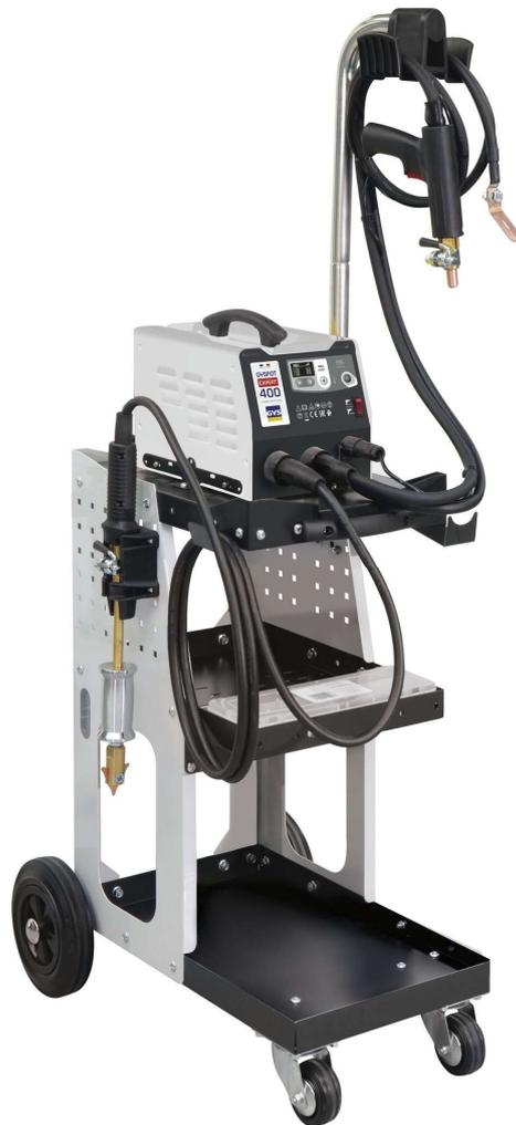
Stahl-Ausbeulspotter mit hoher Ausgangsleistung bis 3800 A. Einfache und intuitive Bedienung durch wahlweise automatische oder manuelle Schweißauslösung und benutzerfreundliches Bedienfeld. Die zusätzlich unabhängige Einstellung von Schweißstrom und Zeit ermöglicht eine noch präzisere Kontrolle des Wärmeeintrages auf z.B. sehr dünnen höherfesten Blechen. **Lieferung auf Wagen Universal 800 und Zubehörbox.**
