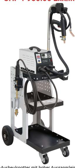
1-phasiger 230V Stahl-Ausbeulspotter mit hoher Ausgangsleistung bis 3800 A. Einfache und intuitive Bedienung durch wahlweise automatische oder manuelle Schweißauslösung und benutzerfreundliches Bedienfeld. Die zusätzlich unabhängige Einstellung von Schweißstrom und Zeit ermöglicht eine noch präzisere Kontrolle des Wärmeeintrages auf z.B. sehr dünnen höherfesten Blechen. Lieferung auf Wagen Universal 800 und Zubehörbox.
