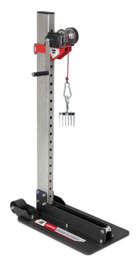
Capacité de tirage jusqu'à **350 Kg** sur toute la hauteur. Hauteur de tirage max. de **1.30 m**. Tirage par treuil à manivelle avec corde Ø6 mm (résistance à la traction de **1,5 tonnes**). Système de glissière pour ajuster la hauteur de tirage, en quelques secondes et sans outils. Renvoi d'angle pour permettre le tirage vers le bas.
