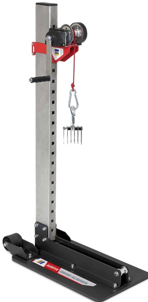
Zugkraft von bis **350 kg** über die gesamte Höhe des Gerätes. Maximale Zughöhe von **1,30 m**. Kurbelwinde mit  $\varnothing$  6 mm Drahtseil (**1,5 Tonnen Zugfestigkeit**). Schiebeseite zur sekundenschnellen und werkzeuglosen Einstellung der Zughöhe. Abgewinkeltes Getriebe, um das Ziehen nach unten zu erleichtern. Leichtes Gerät (31 kg) gut mobil einsetzbar durch die beiden Räder. Niedriger Geräuschpegel bedingt durch den Hochleistungsschalldämpfer
