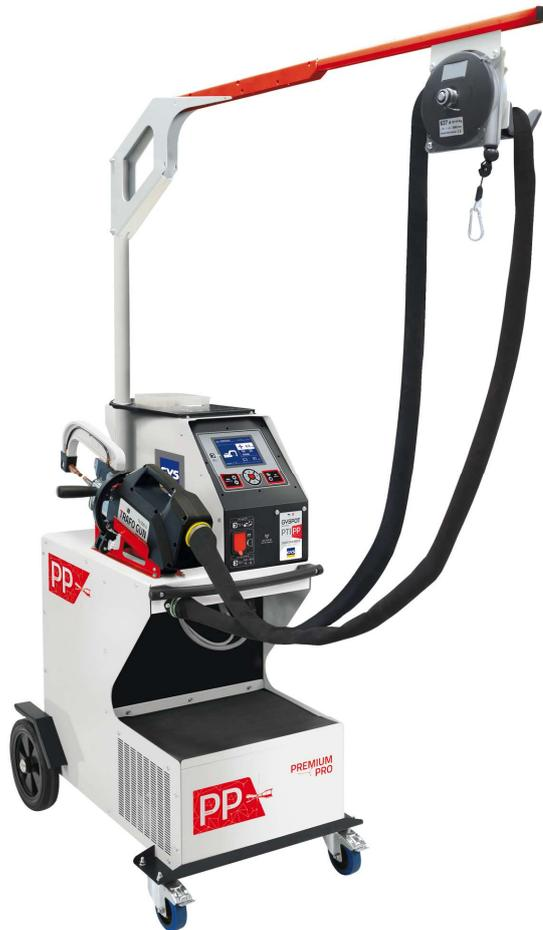
Der GYSPOT PTI PREMIUM PRO erfüllt die aktuellsten Anforderungen bei der Karosserieinstandsetzung– besonders für hoch- und höherfeste Stahlbleche mit 550daN Spannkraft und 14500A Schweißstrom. Dank der kompakten, die neueste Transformatorzangen-Technologie darstellende, G-Zange ist ein Kosten sparendes Arbeiten bei geringer Stromaufnahme, abgesichert durch 25 Ampere Netzsicherungen, möglich. Extrem einfache Bedienung durch den EASYMODUS Automatisches Schweißen ohne Parametereinstellung.
