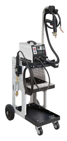
Dédié aux différentes opérations de débosselage et de redressage du carrossier, le GYSPOT EXPERT 230 est un appareil haut de gamme doté d'une puissance atteignant 3800 A. Le réglage indépendant du courant et du temps de soudage permet un contrôle précis de l'impact de la soudure sur les tôles zinguées et particulièrement les tôles fines.
