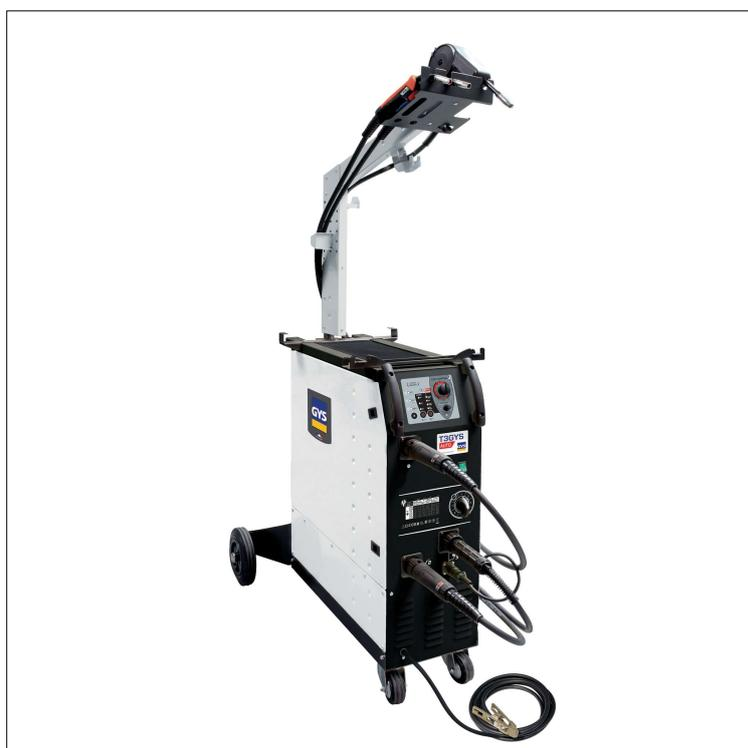
**LE T3 GYS AUTO** est un MIG-MAG triphasé synergique, avec 3 connecteurs torche, recommandé pour le soudage des aciers doux, inox, haute résistance, des aluminiums et le soudo-brasage. 400V – 15 à 200 ampères
