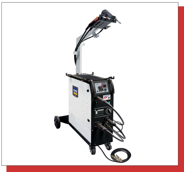
Die T3 GYS Auto ist eine synergische geregelte Schutzgasschweißanlage, konzipiert für Schweißarbeiten an Stahl-, Edelstahl- und Aluminiumdünnblechen. Es verfügt über einen 4-Rollen Drahtvorschub und eignet sich zum MIG- Löten von hochfestem Stahl mit CuSl. (ideal für Karosseriereparaturarbeiten). **15 bis 200 Amper.**
