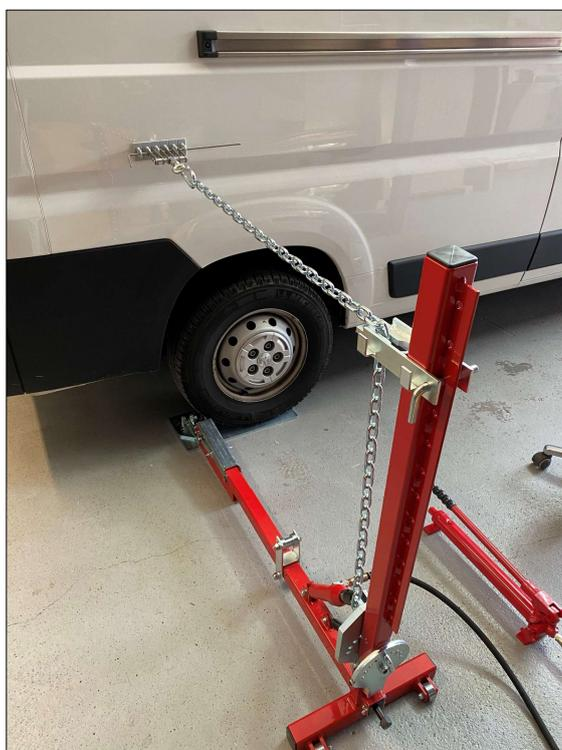
Le X-Monster 775 est le complément idéal pour le débosselage en carrosserie. Il est particulièrement adapté pour redresser des bosses importantes, aussi bien dans la partie des bas de caisses des véhicules que dans des positions bien moins accessibles. Il est équipé d'un bras positionnable perpendiculaire au tir entraîné par un vérin hydraulique. Léger, peut être facilement déplacé grâce à 2 roues appliquées sous le poteau vertical. **Poids 32 Kg / Force de tirage 1'200 Kg**
